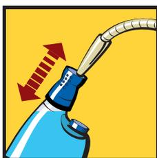
2. Вставьте аспирационную канюлю в мерный колпачок и нажмите на колпачок 1 раз.
